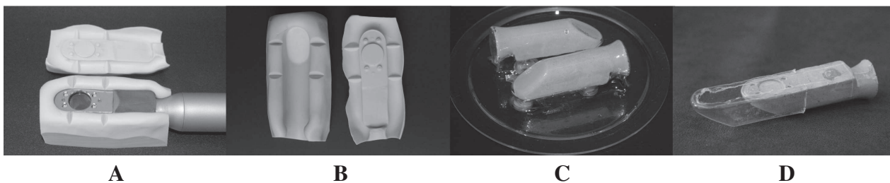
Figura 3 - A: vista lateral do material de moldagem colocado na porção inferior e lateral da ponta ativa até o plano de abertura da câmera e os cortes em forma de V em ambos os lados, na porção superior da moldagem. B: moldagem da porção superior do equipamento. Uma nova porção de material de moldagem foi acondicionada na ponta ativa a fim de fazer uma cópia da porção superior (contra-mufla). C: modelo revestido de acetato. D: cópia da câmera intra-oral e suporte-guia de acetato com a respectiva abertura.
